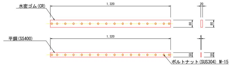
※水密ゴム・平鋼の形状については、施工前に再度計測を行い確認する事。
